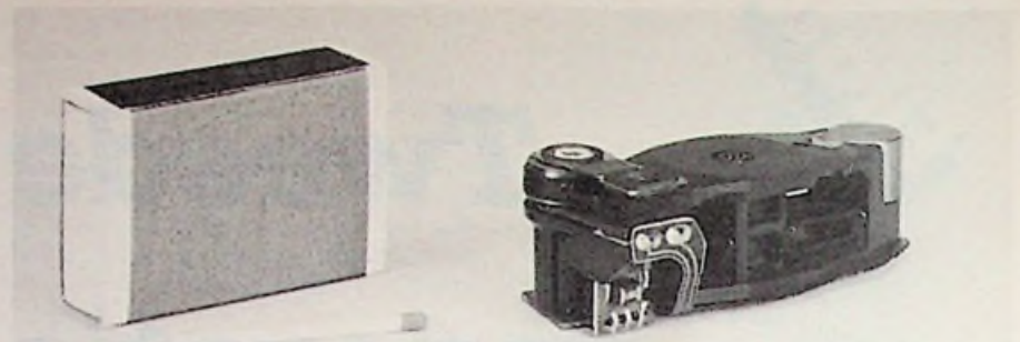
Afb. 1 De nieuwe ondeelbare eenheid van de optische pickup in zwaaiarm CDM2. Dit dynamische wonder vormt weer een onafscheidelijk geheel met het chassis in afb. 3 en 7.
