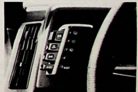
Afb. 4 Het dashboard van de Subaru XT omvat satellieten links en rechts van het stuurwiel. De foto toont de linker satelliet met onder meer de druktoets voor de hoogte-instelling (Height) van de auto (foto H.H.).
